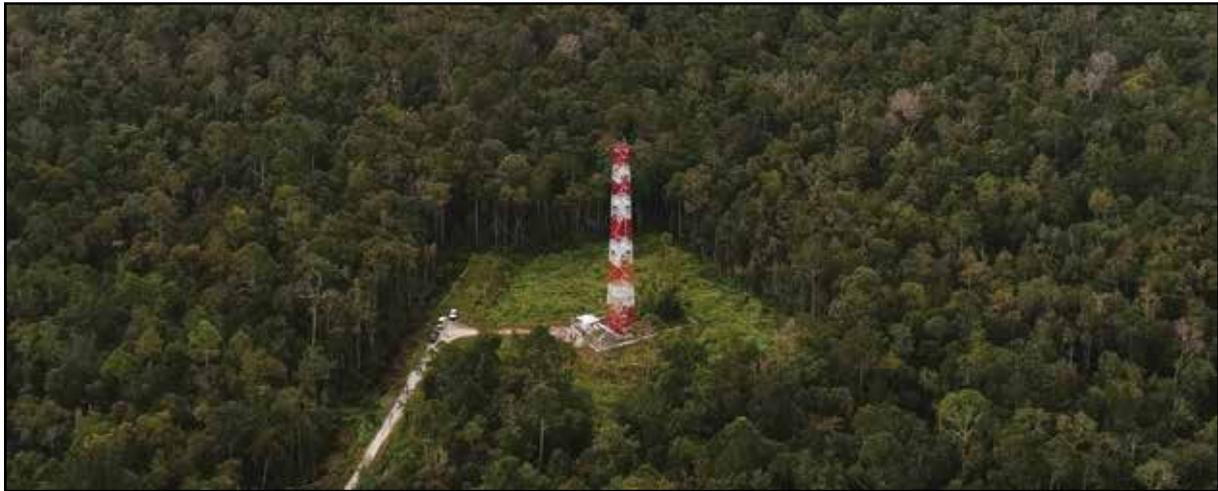
Menara Pengukuran Fluks Gas Rumah Kaca setinggi 48 meter di area RER di Semenanjung Kampar melakukan pengukuran dengan frekuensi pengambilan data yang tinggi dalam skala ekosistem.
